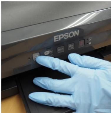
3. プリンターの電源を切ります。(誤って電源ボタンを押してしまいますとヘッドが動き出して危険ですのでコンセントも抜いておくと安全です。)
