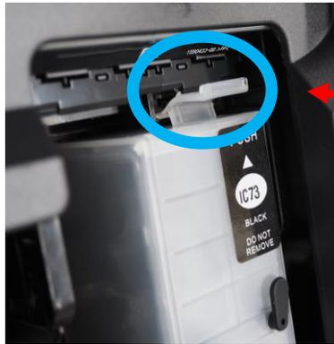
4. インクを充填したインクカートリッジをプリンターにセットし、**青の線で囲んだ部分**がカチッと言うまで押し込んでください。
