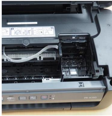
3. プリンターを起動してください。初回起動時にはプリンターヘッドがカートリッジセット位置にヘッドが移動します。
