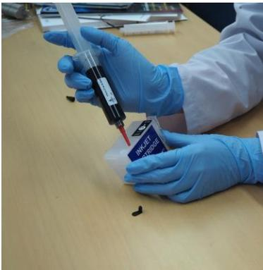
2. インクカートリッジ1個の黒い栓(B)を外し、iのドライキュア Ag-JB が溢れないよう充填します(約20mL)。充填後は、Bの栓を戻してください。
