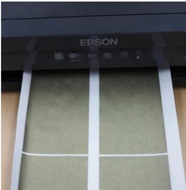
8. ドライキュアAg-JBがヘッドから出始めるまで、ベタ塗り印刷パターンもしくはそれに近い画像を用いてインクが十分に吐出されるまで印刷を繰り返してください。
