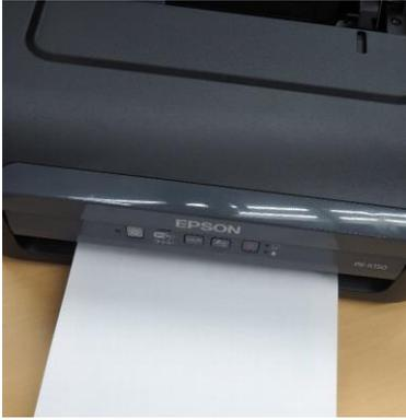
11. ドライキュアAg-JBがヘッドから出なくなり何も保存液しか印刷されなくなるまで、ベタ塗り印刷パターンもしくはそれに近い画像を用いてインクが十分に吐出されるまで印刷を繰り返してください。
