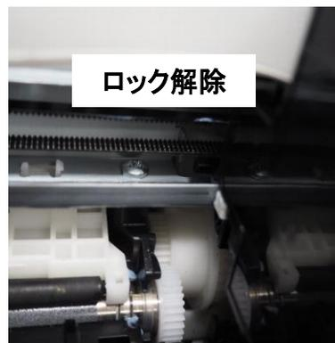
5. 押し込んだプリンターヘッドの左奥、図の位置にある歯車にの上部に掛かっているロックを細い棒で上へ押し上げ外します。
