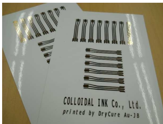
弊社金ナノインクを用いてインクジェット印刷を行った金電極パターン
